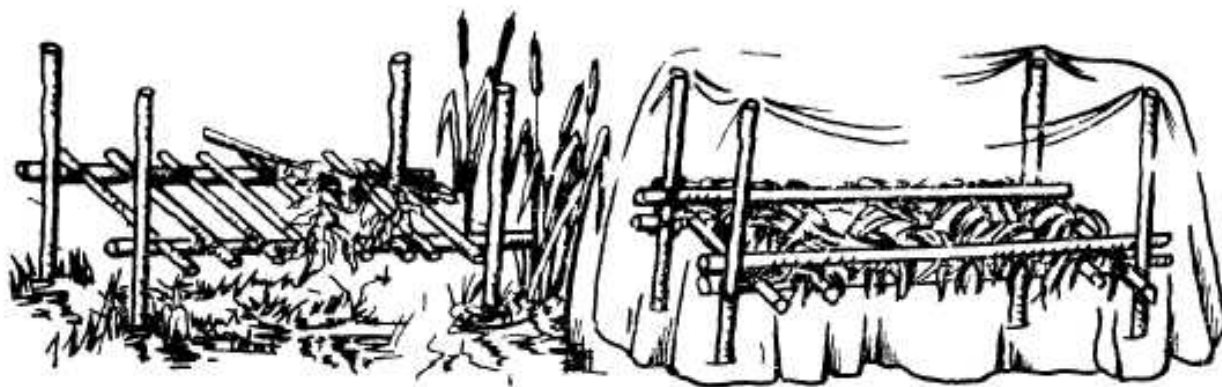
Рис. 93. Устройство укрытия для отдыха в болотистой местности
